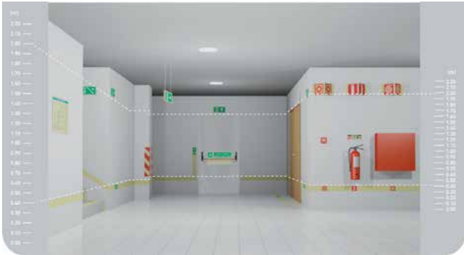
Figura 6 – Sinalização de Emergência
