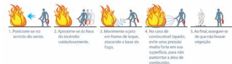
Figura 17 – Utilização de Extintores Portáteis
